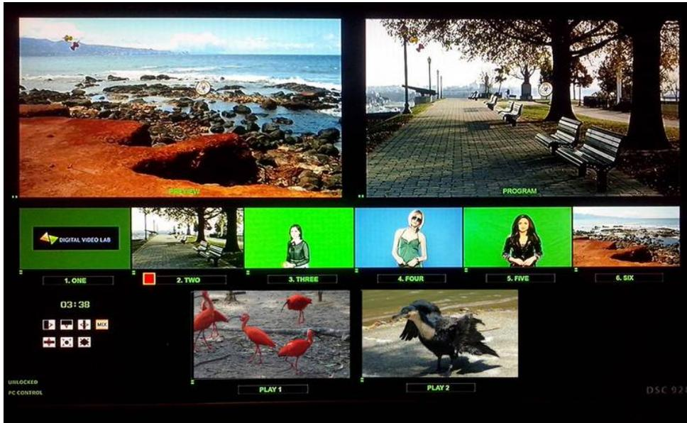
Выход HDMI Multiscreen расположенный на задней панели микшера должен быть подключен к LCD монитору или телевизору, имеющему HDMI вход и поддерживающему разрешение 1920X1080i пикселей при 50Гц. В настоящее время мониторы с таким разрешением распространены и недороги. При выборе компьютерного монитора все же следует проверить на корректную работу в режиме 1920X1080iX50Гц, также следует обратить внимание на возможность работы монитора в режиме полного отображения экрана.
